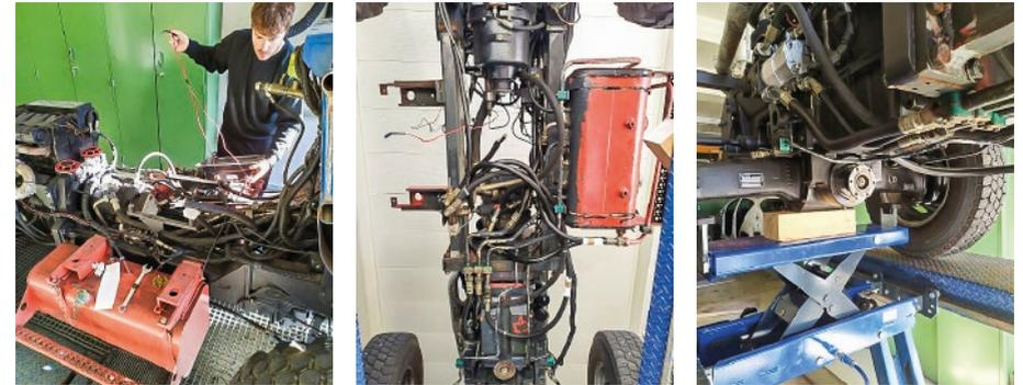
Die Studenten der FH Ost sind an der Erstellung des Lastenhefts, haben mit der Demontage des Dieselantriebs sowie der definitiven Auslegung der Batterie und allen weiteren Hauptkomponenten begonnen.
